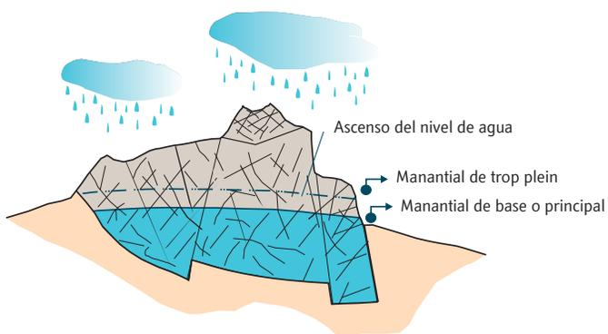
■ Roca permeable    ■ Roca permeable saturada en agua    ■ Roca impermeable
